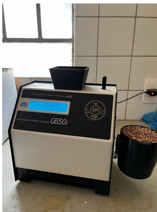
Figura 20 – Equipamento utilizado para determinação do peso hectolitro dos grãos de trigo, modelo Gehaka AGRI G650i.
